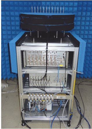
図 10 干渉モニタリング装置外観 (Sub6GHz 帯測定時)
