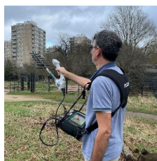
電子コンパス付き指向性アンテナとGPS位置情報から信号源位置を探索 (インターフェアレンスファインダ)
